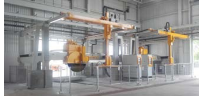
Impianto di taglio costituito da due tagliablocchi NT4, equipaggiate con scaricatore automatico mod. AEREO.
