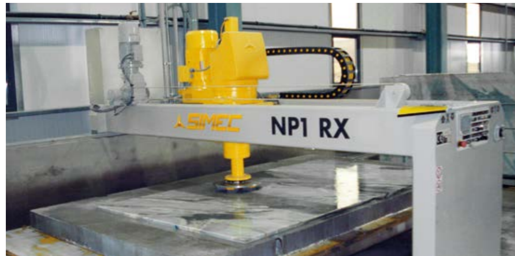
Lucidatrice NP1 durante la lucidatura di una lastra di marmo.
